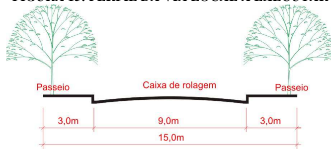
FIGURA 15: PERFIL DA VIA LOCAL A EXECUTAR
