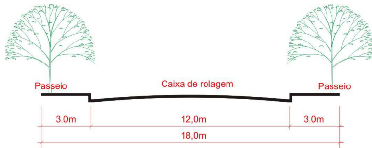
FIGURA 14: PERFIL DAS VIAS COLETORAS A EXECUTAR
