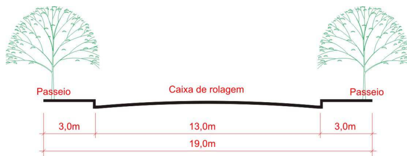
FIGURA 16: PERFIL DA VIA PERIMETRAL A EXECUTAR
