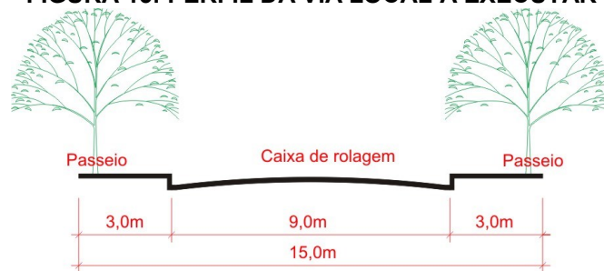
FIGURA 15: PERFIL DA VIA LOCAL A EXECUTAR
