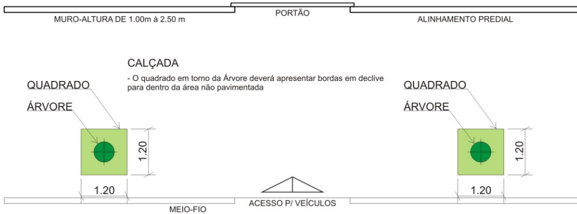
FIGURA 10: MODELO DE CALÇADA PARA ÁREA COMERCIAL
