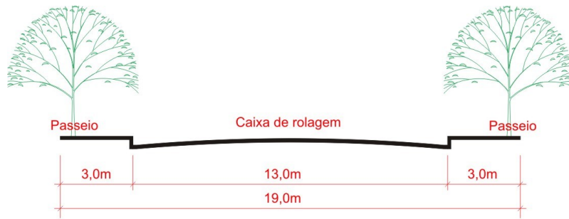
FIGURA 16: PERFIL DA VIA PERIMETRAL A EXECUTAR
